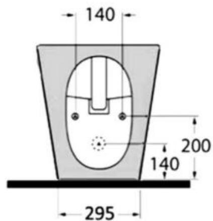
Qui sopra sono illustrate le misure e i componenti del **bidet filo muro**, prima di effettuare il montaggio bisogna consultare la presente scheda tecnica.
